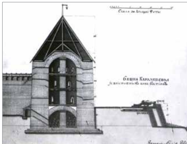
Фото 6. Разрез Королевской башни. 1730 г. Чертёж, сделанный инженером Н. Людвигом к проекту перестройки.
